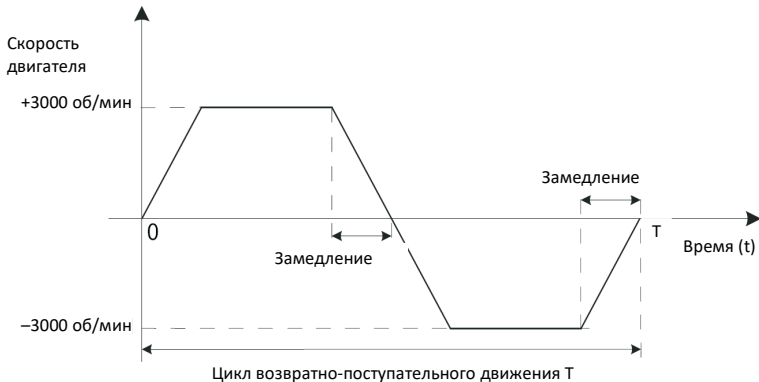
Рис. 2-13. Пример кривой скорости двигателя (без внешнего момента нагрузки)
