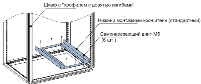
Рис. 1-10 Установка нижнего монтажного кронштейна
