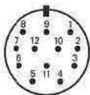
Штыревая часть контактного разъема со стороны импульсного кодера
